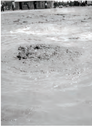
写真2.1.14 新潟明訓高校の校庭で発生した噴砂・湧水 65) (写真提供：関東学院大学 工学総合研究所 若松 加寿江 氏/竹内 寛 氏 撮影)
