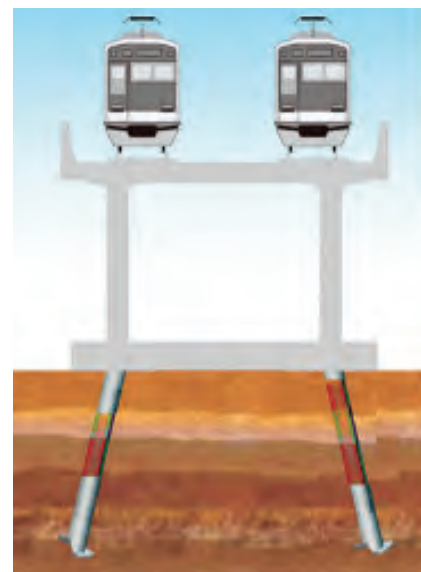
図2.6.8 鉄道構造物基礎の斜杭イメージ 26)
