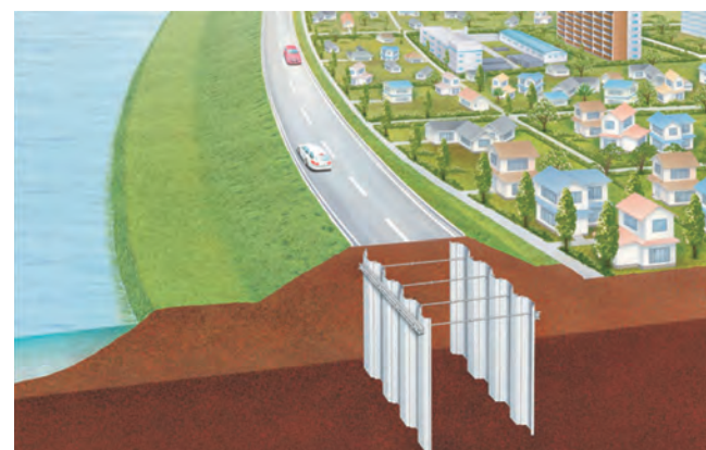
図2.5.7 鋼矢板芯壁堤の基本構造イメージ
