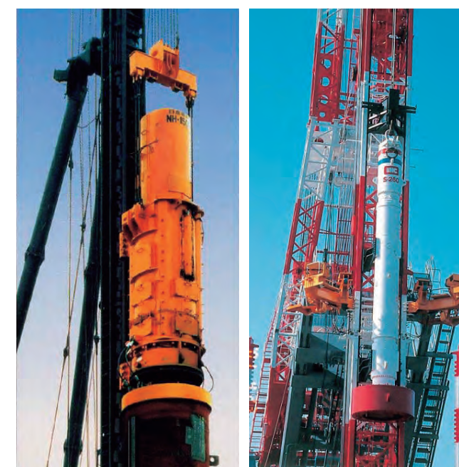
(a) NH-150B 4) 注 (b) S-280 5) 写真2.2.1 油圧ハンマ 注：現在、日本車両製造では、油圧ハンマの生産を行っていない。
