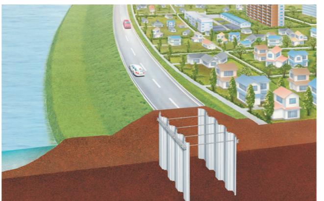
図2.5.7 鋼矢板芯壁堤の基本構造イメージ
