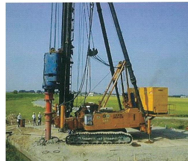
写真2.5.1 杭頭回転方式の例<sup>8)</sup>
