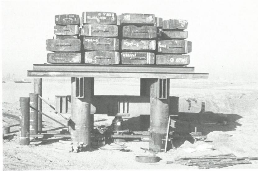
写真-4 実荷重による載荷試験装置
