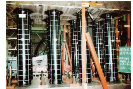
写真-2 杭体の損傷状況 (-12δy)
