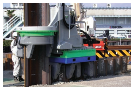
写真-3 ハット形鋼矢板900圧入機(試作機)
