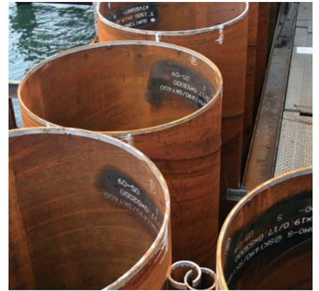
編鋼管継手の採用でせん断耐力は5倍、基礎全体の水平抵抗力が向上する
