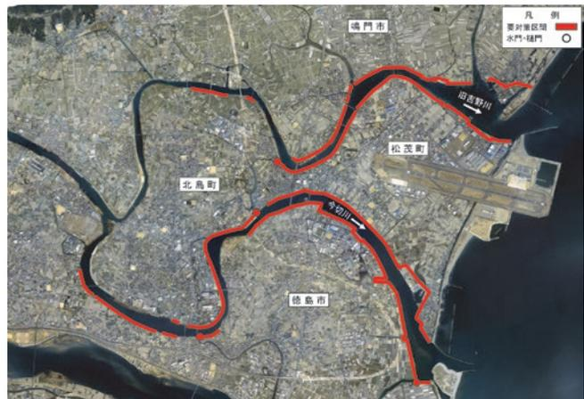
■吉野川位置図および河川堤防の地震・津波対策区間
