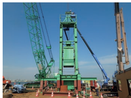
■ 105トンのウェイトを用いて実施された急速载荷試験の状況
