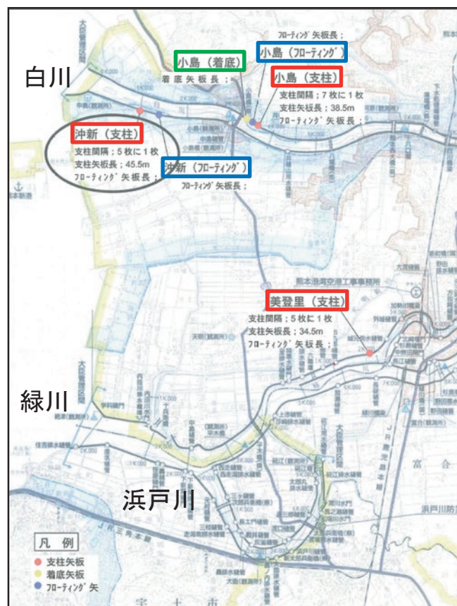
図6 沈下対策鋼矢板の試験施工箇所
