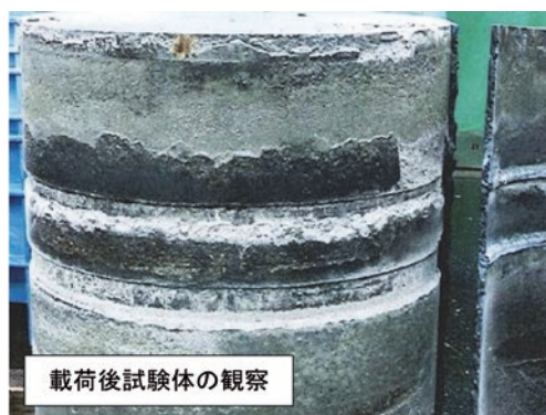
写真7 鋼管内コンクリートの押し抜き試験
