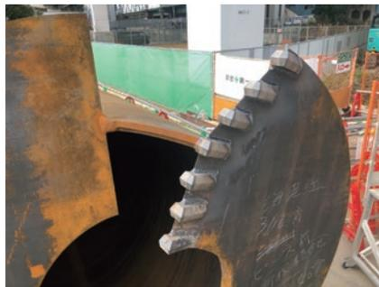
■回転杭、先端掘削補助刃
