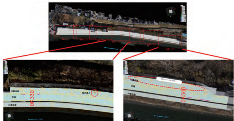
図7 地表面不陸測定状況 (区間③)
