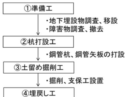
図-5.3.1 橋台前面補強の施工フロー
