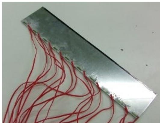
参考 写真 6.3 アルミ板とひずみゲージ
