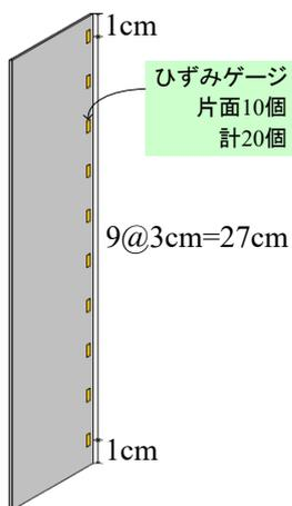
参考 図 6.2 ひずみゲージの添付間隔
