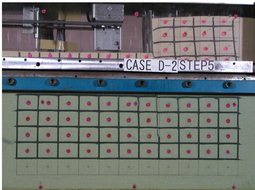
参考 写真 4.6 ケース D-2 (根入れ長  $2.5/\beta$ 、 $Dr=61.6\%$ ) ステップ 5 波 (正弦波 30G 波) 加振後
