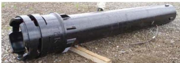
写真-4.4 3点支持式杭打ち機用のヤットコ
