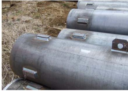
写真－2.1 回転金具の例(杭頭回転方式)
