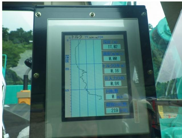
写真-5.2 小型杭打ち機モニター写真の例
