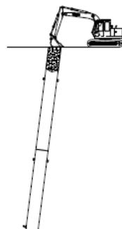
ヤットコを撤去後、全周回転機を移動、杭穴を埋め戻し杭打設完了
