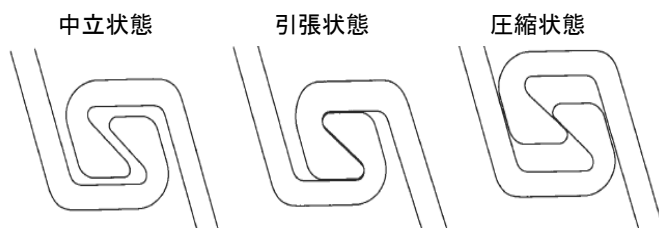
図-8.0.1 継手の嵌合状態
