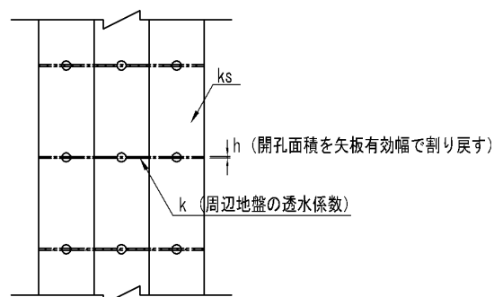
図-4.1.2 透水孔の面積に相当する通水要素を設定する方法
