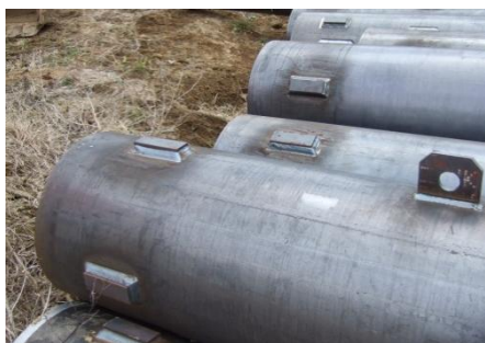
写真 5.8.1 回転金具の例（杭頭回転方式） （出典 5.8-⑩ ）
