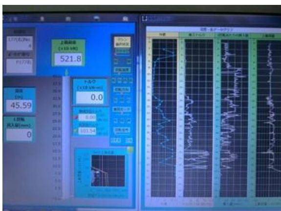
写真5.8.8 施工管理装置のモニター写真の例 (出典 5.8-10 )
