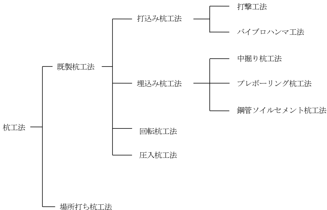
図 5.1.3 杭の施工法による分類
