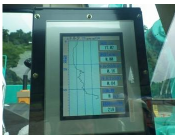
写真5.8.9 小型杭打機モニター写真の例 (出典 5.8-19 )
