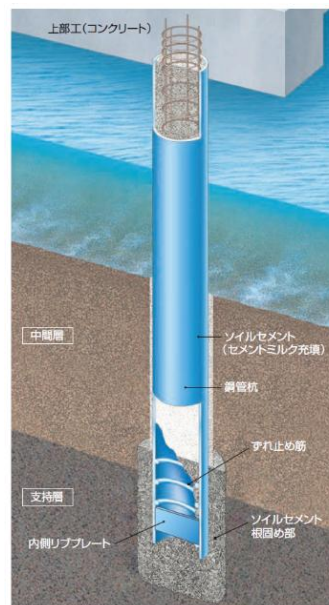
図 5.10.16 RS プラス工法杭のイメージ図 (出典 5.10-27 )
