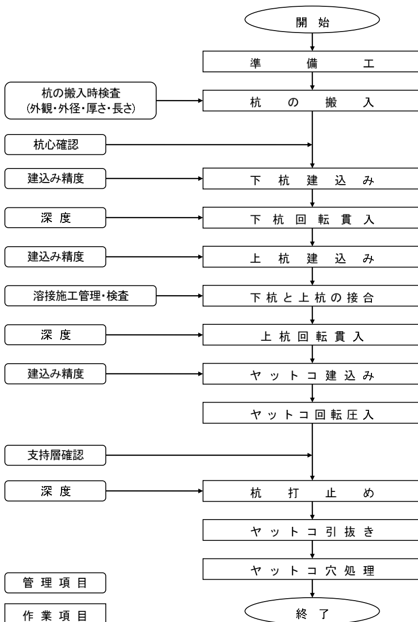
図 5.8.1 回転杭の標準施工フロー (出典 5.8-②)
