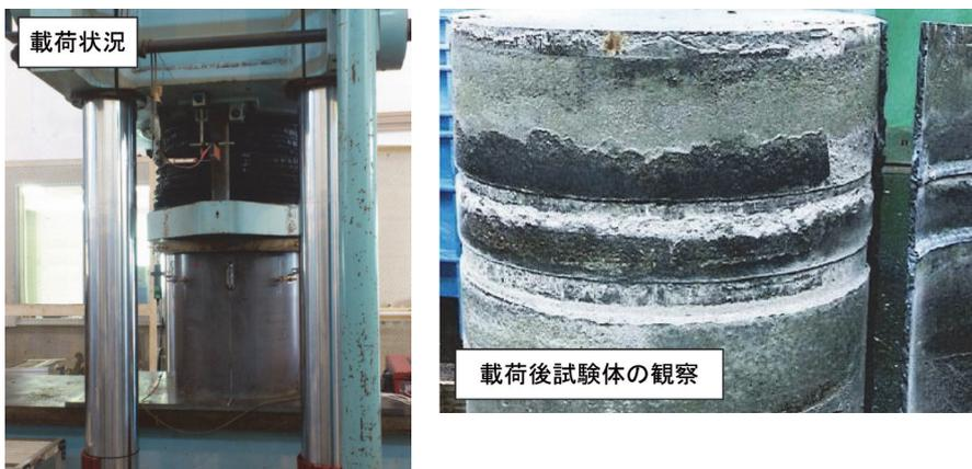
写真7 鋼管内コンクリートの押し抜き試験
