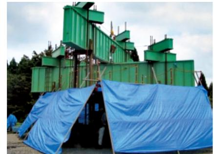
写真6 中掘り杭工法コンクリート打設方式の載荷試験状況
