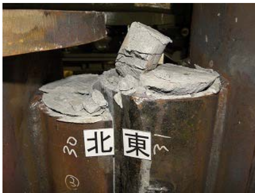
写真 2.3 試験終了後の継手上下のモルタルグラウトの状況
