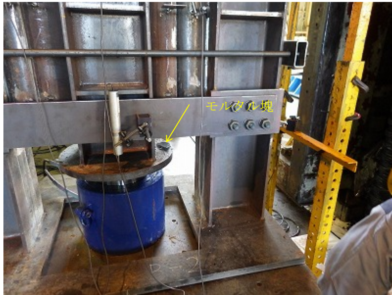
写真 2.2 1stSTEP 2 回目負側載荷終了後の状況
