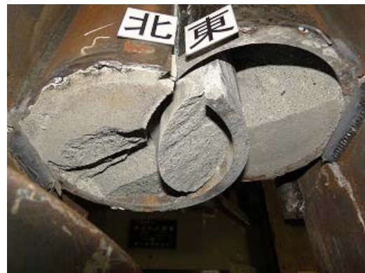
写真 2.3 試験終了後の継手上下のモルタルグラウトの状況
